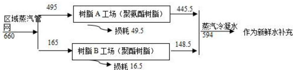
图 4.4-9 本项目蒸汽平衡示意图 (单位: t/a)
